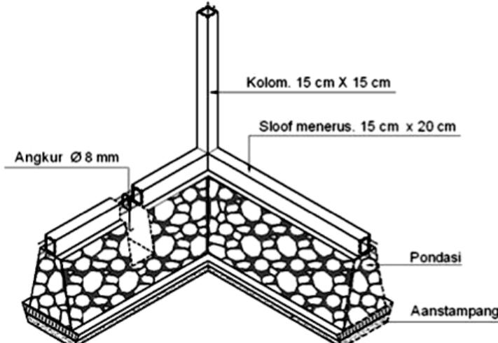
Isometrik Pondasi Balok dan Kolom
